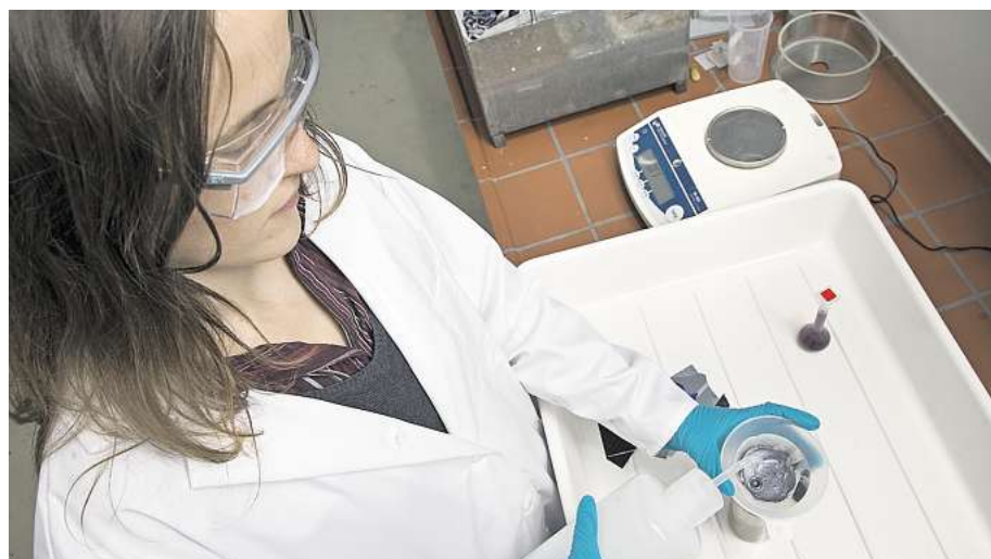
Umweltingenieurin Anja Müller hält ein Siliziumbruchstück in einem Messbecher, der mit einer Ätzflüssigkeit gefüllt ist. Die ständige Optimierung des Ätzprozesses ist entscheidend, um Zellen und Wafer möglichst vollständig zu reinigen.
