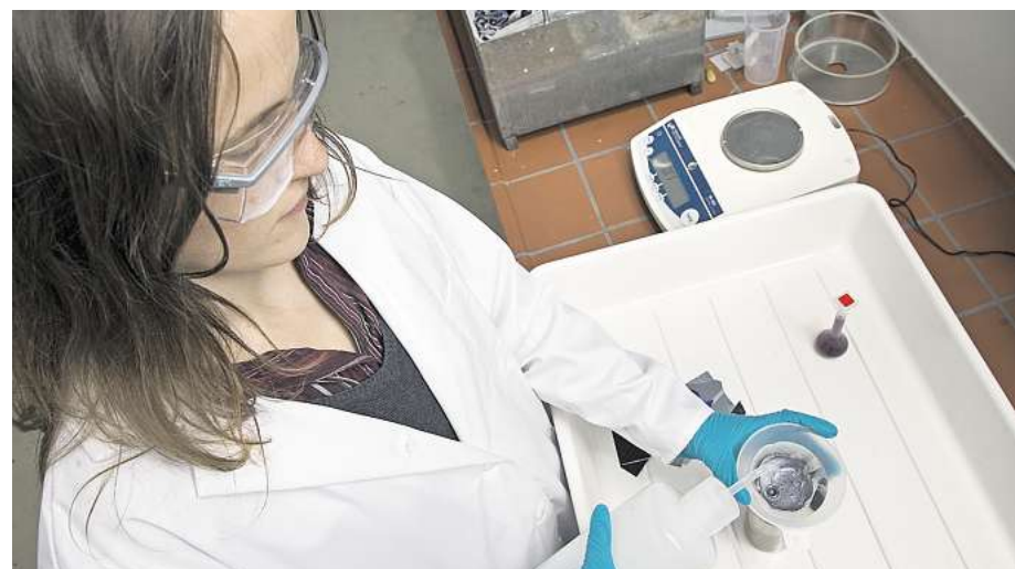
Umweltingenieurin Anja Müller hält ein Siliziumbruchstück in einem Messbecher, der mit einer Ätzflüssigkeit gefüllt ist. Die ständige Optimierung des Ätzprozesses ist entscheidend, um Zellen und Wafer möglichst vollständig zu reinigen.
